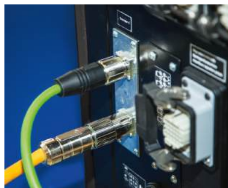
Servokabel: Anschluss von Motor- und Encoderkabel direkt am Regelgerät
