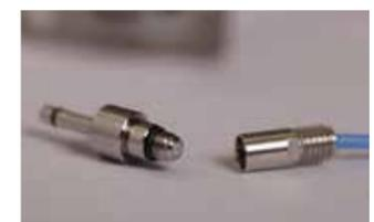
Innendruckfühler: Direkt wirkender Piezo-Drucksensor von BAUMER
