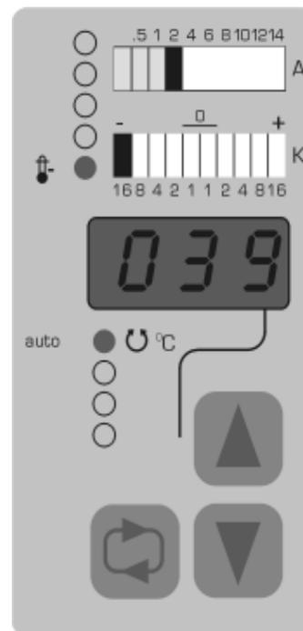
Entsprechend der Differenz von IST-Temperatur zu SOLL-Temperatur und entsprechend der Vorgabe des Grenzwertes für die Erkennung von Untertemperatur leuchtet die Untertemperatur-Anzeige (11) auf.
