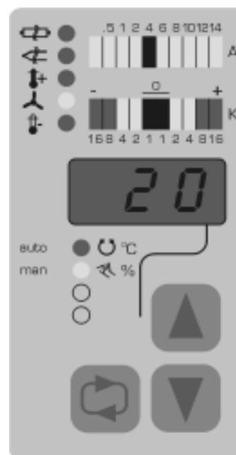
In diesem Modus kann eine Heizzone zu Testzwecken im Stellerbetrieb gefahren werden. Die Regelabweichungsanzeige (2) reagiert entsprechend des eingestellten Temperatur-Sollwertes. Bei Überschreiten der Temperaturgrenzwerte reagieren die entsprechenden Ausgänge. Liegt die Temperatur  $>5K$  über dem Übertemperatur-Grenzwert, öffnet das zusätzliche Lastrelais.
