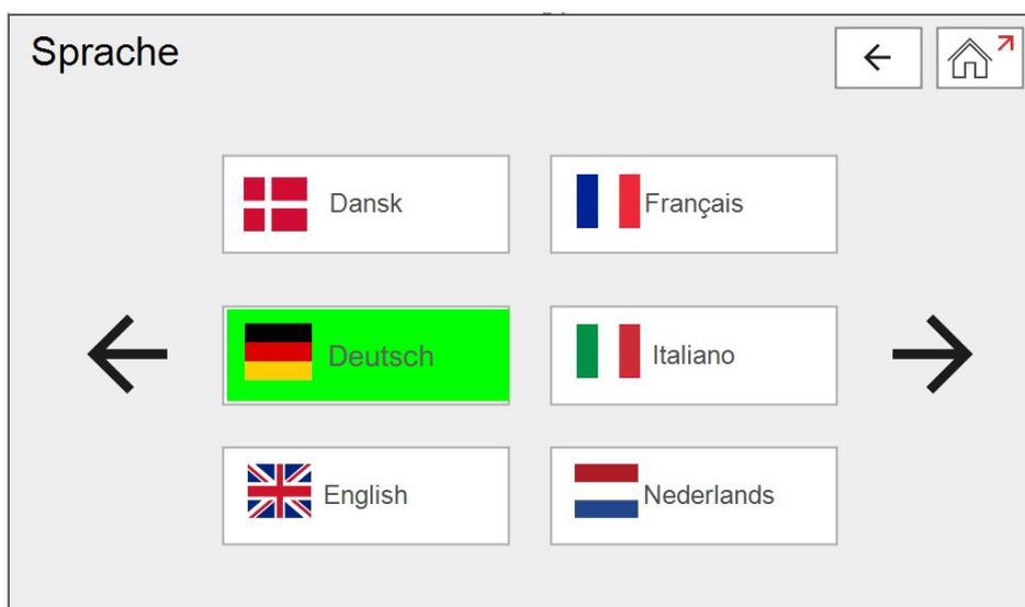
Die Anwahl der gewünschten Sprache wird durch grüne Hinterlegung der betreffenden Taste bestätigt. Sämtliche Begriffe in allen Menüs bzw. Bildschirmen werden automatisch angepasst. Die Zahl der verfügbaren Sprachen umfasst mehrere Bildschirmseiten, sie wird laufend erweitert. Die aktuelle Sprache wird auch unten links auf dem Homescreen angegeben.
