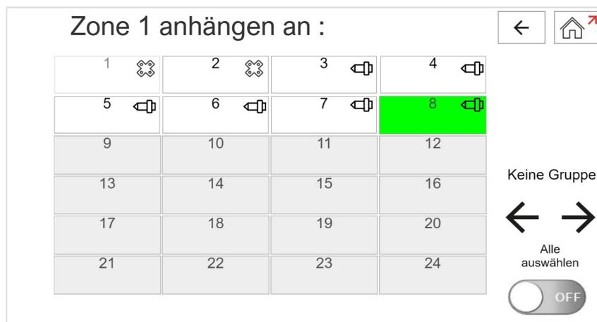
Zum Anhängen das Feld „Zone“ die gewünschte Führungszone antippen. Anschließend den Schiebeschalter auf „ON“ schalten.
