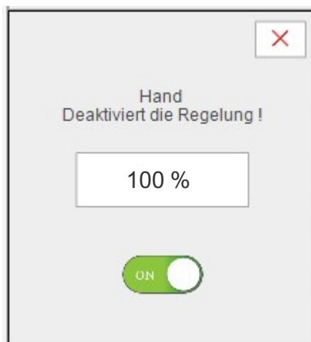
Zum Aktivieren des Handbetriebes den Schiebeschalter auf „ON“ schalten. Entspricht der gespeicherte Wert nicht den Anforderungen, dann das Anzeigefeld antippen. Daraufhin öffnet sich die bekannte Zehnertastatur, hiermit den gewünschten Stellgrad eingeben, der Wert des Hand-Stellgrades wird dann im Anzeigefeld dargestellt . Anschließend mit dem roten Kreuz das Dialogfeld schließen.
